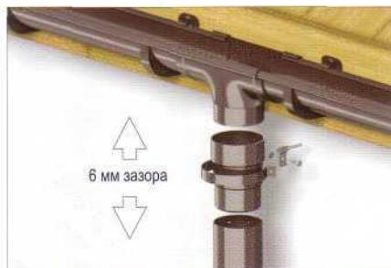
**11** Установить водосточную трубу, соединяя ее со сливной воронкой при помощи муфты трубы. Хомуты труб крепить на сужении муфты к стенам при помощи крюков с шурупом. Рассстановка креплений: трубы крепится к стене здания каждые 2 метра.
