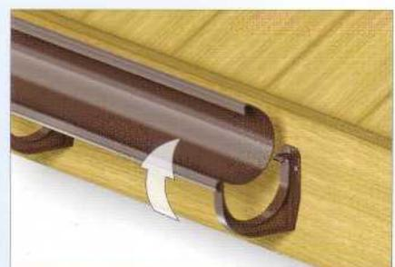
**5** Установить желоб в держателях. Воткнуть передний носик держателя в передней фланец желоба и повернуть желоб назад до его защелкивания на заднем выступе держателя.
