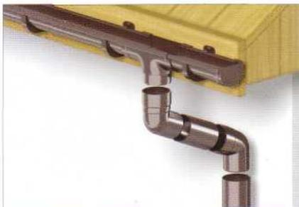
**14** Если водосточную трубу невозможно замонтировать непосредственно под сливной воронкой (напр. при выступающем навесе) то соединение следует выполнить при помощи двух колен и отрезка водосточной трубы.
