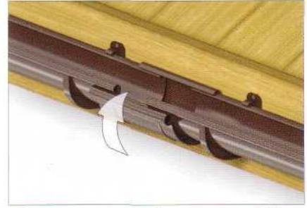
**8** Соединить отрезки желоба при помощи муфт. Длину напуска желоба в муфте выполнить соответственно метке на муфте. Расстояние держатель / край муфты не должно превышать 15 см.
