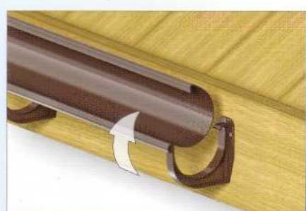
5 Установить желоб в держателях. Вткнуть передний носик держателя в передний фланец желоба и повернуть желоб назад до его защелкивания на заднем выступе держателя.
