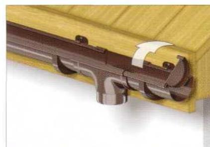
**10b** Универсальная заглушка подходит левому и правому концам желоба. Передний фланец заглушки вставить в передний фланец желоба и повернуть заглушку вглубь желоба до защелкивания на заднем фланце желоба.
