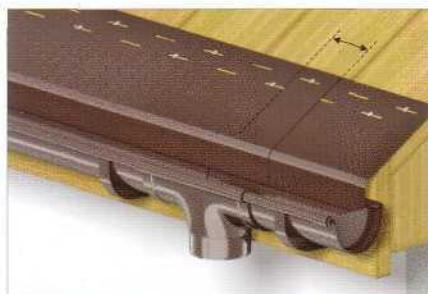
**17** Фартуки свеса прибить к доске карниза. Гвозди вбивать в отверстия перфорации в фартуке. Между шляпкой гвоздя и фартуком оставить зазор ок. 1 мм. Фартуки соединять внахлестку шир. 8 см.
