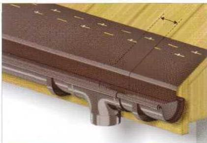
**17** Фартуки свеса прибить к доске карниза. Гвозди вбивать в отверстия перфорации в фартуке. Между шляпкой гвоздя и фартуком оставить зазор ок. 1 мм. Фартуки соединять внахлестку шир. 8 см.
