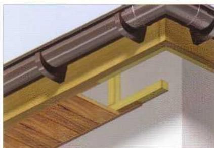
**18** Монтаж подпотолочной панели выполняется при помощи планок типа J, прибитых гвоздями к балкам или обрешетине навеса кровли (макс. каждые 40 см). Подпотолочную панель всунуть в планку типа J. Подпотолочные панели соединять между собой на защелку и крепить с расстановкой не более 30 см.
