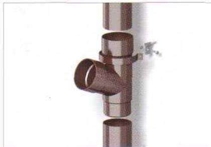
**15** Монтируя тройник или ревизию, необходимо крепить их на стене здания при помощи хомута с крюком. Хомут монтировать на фасонной части. Обеспечить ок. 6 мм зазора в соединении.
