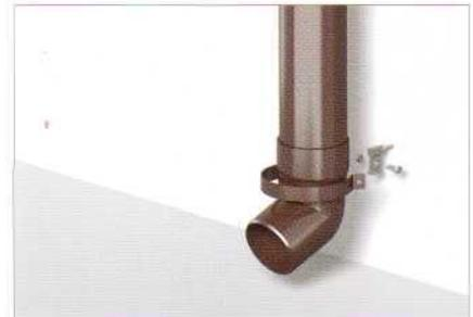
**16** Установить колено как выходное отверстие водосточной трубы. На фасонной части замонтировать хомут.
