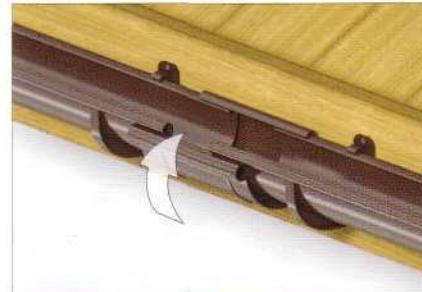
**8** Соединить отрезки желоба при помощи муфт. Длину напуска желоба в муфте выполнить соответственно метке на муфте. Расстояние держатель / край муфты не должно превышать 15 см.
