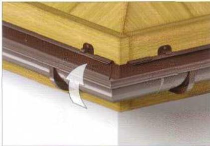
**9** Установить угольники на желобе. Вложить задний фланец желоба в задний фланец угольника и защелкнуть передний фланец желоба в торцевом фланце угольника.
