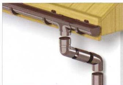
**14** Если водосточную трубу невозможно замонтировать непосредственно под сливной воронкой (напр. при выступающем навесе) то соединение следует выполнить при помощи двух колен и отрезка водосточной трубы.
