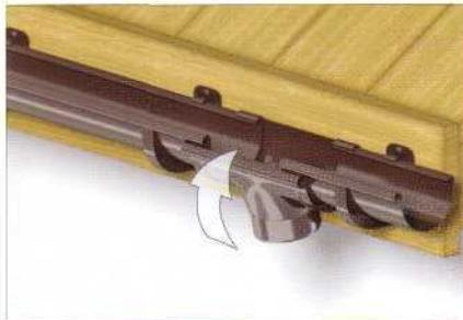
**7** Установить сливную воронку. Задний край воронки заложить на задний фланец желоба. Повернуть воронку вперед до защелкивания переднего фланца на торцевом фланце желоба. Длину напуска желоба в воронке подобрать соответственно метке на фасонной части.
