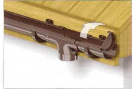
**10b** Универсальная заглушка подходит левому и правому концам желоба. Передний фланец заглушки вставить в передний фланец желоба и повернуть заглушку вглубь желоба до защелкивания на заднем фланце желоба.
