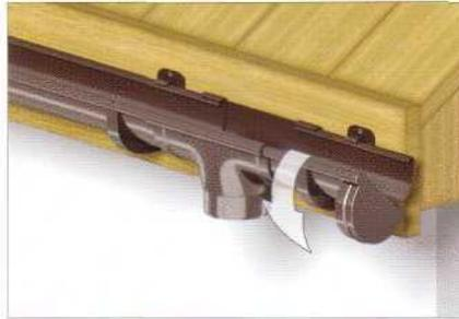
**10a** Установить правые и левые заглушки. Заглушку устанавливать следующим образом: передний фланец заглушки всунуть в передний фланец желоба, а затем повернуть заглушку вверх до защелкивания на заднем фланце желоба.
