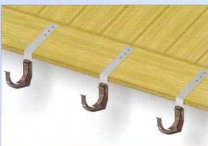
**3b** Существует возможность выполнения креплений непосредственно на стропильной ноге или доске свеса. Для этого держатели желоба следует привинтить к стальной планке, изогнутой соответственно уклону кровли. Расстояние между планками не может превышать 60 см. (Уклон желоба 0,3%).
