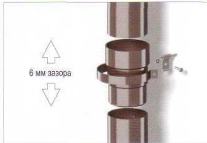
**12** Отрезки труб соединять между собой при помощи муфт трубы. Хомуты крепить на сужении муфты. Оставить ок. 6 мм зазора в соединении водосточная труба – муфта трубы.
