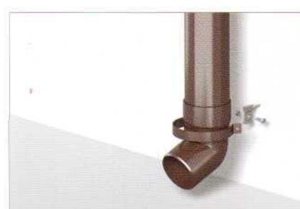
**16** Установить колено как выходное отверстие водосточной трубы. На фасонной части замонтировать хомут.
